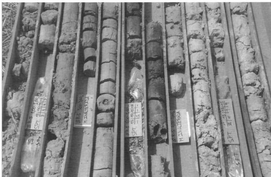
Sondeig núm. 5 on es repeteix la sèrie de manera similar: Sota llims continentals (eluvions) es troben els llots orgànics (foscos) del m. 4, 5 al 7 sota el terreny.
