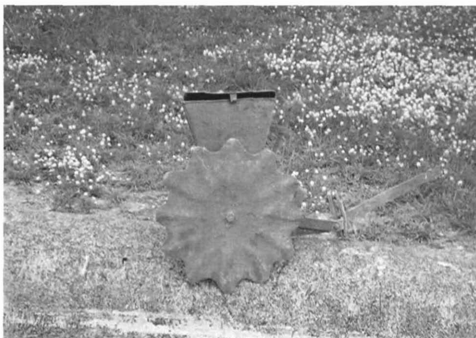
Màquina de sembrar cotó. (S'empenyia manualment)
