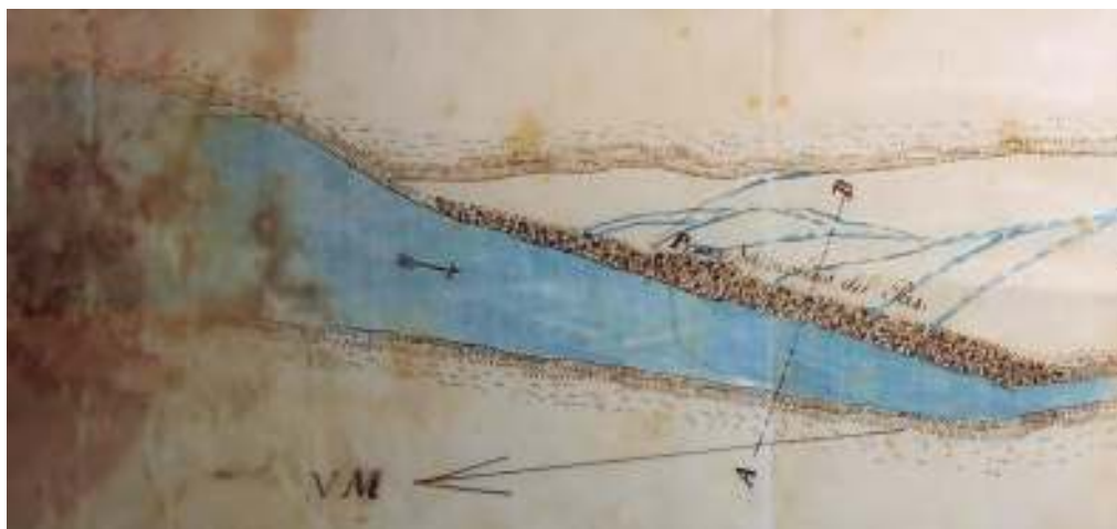
Fotografia 1. Plànol de la resclosa de la Riera, on es desviava l'aigua vers la sèquia del Molí del Pas, tal i com era al segle XIX, feta amb pedres, fang i fusta. Imatge del plànol del 1869 conservat al Fons de la Família Yxart (Arxiu Històric de Tarragona)
