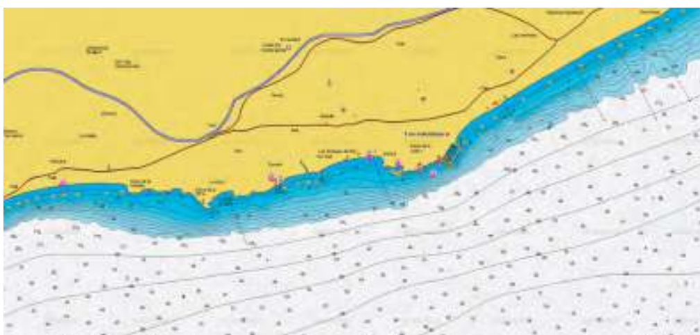
Figura 21: Batimetria general del tram des de La Platja Llarga a la platja de Torredembarra. Ens trobem amb pendents força regulars del 2% , amb tendència a disminuir vers la plataforma, amb probable presència d'aterassaments cimentats fòssils a manera d' antines o atinents . No es denoten canals d'encaixament de la xarxa hídrica actual superficial. Al tram dels Salats i Muntyans es marquen les principals antines
