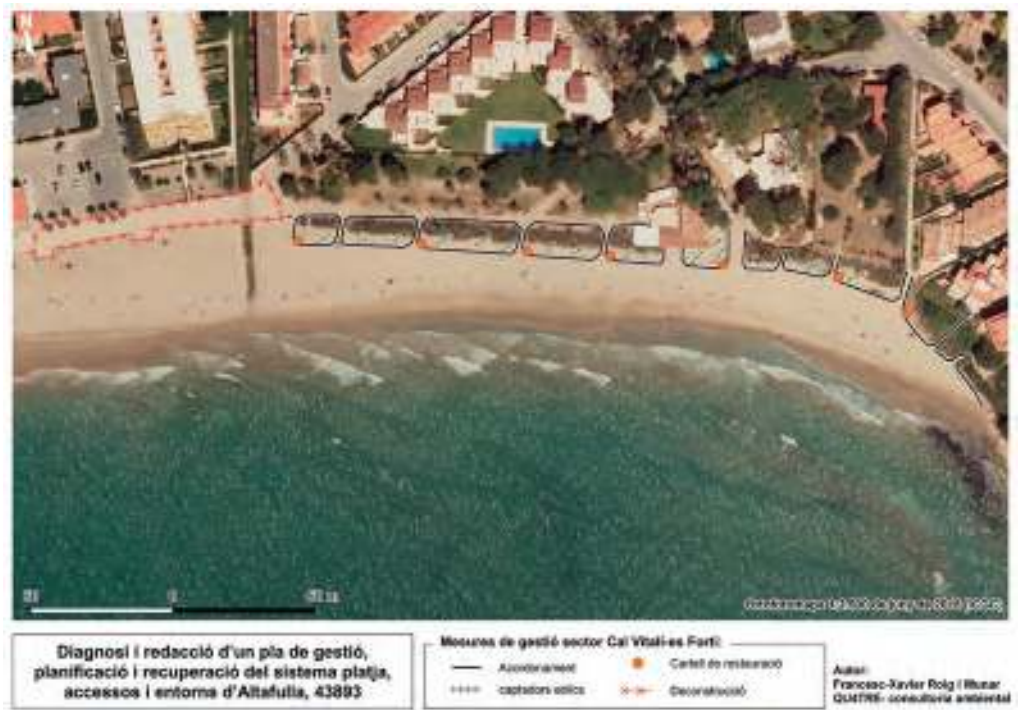
Figura 47: La implementació del Pla de gestió del sistema platja de l'any 2020, (foto superior del tram La Rasa-Voramar) s'iniciava amb la instal·lació de captadors eòlics en diferents àmbits. Aquesta instal·lació es proposava al peu de les atzavares separadores de l'antic càmping Altafulla, pressuposant la retirada de les atzavares, malgrat que no s'apuntava explícitament. Sí que s'apuntaven certes “ deconstruccions ” que posteriorment es concretarien en l' Avantprojecte de millora i adaptació al canvi climàtic... de setembre de 2021
