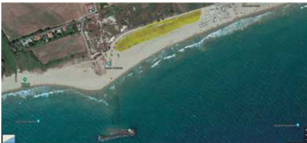
Figura 61: Entorn de la Roca de Gaià, amb el seu espigó, o dic absent, a 200 metres del rocam natural i de 100 metres de llarg, que facilita l'acumulació de sorres al seu entorn, i que permeten traspasar part dels seus volums vers la Platja de Botigues.
