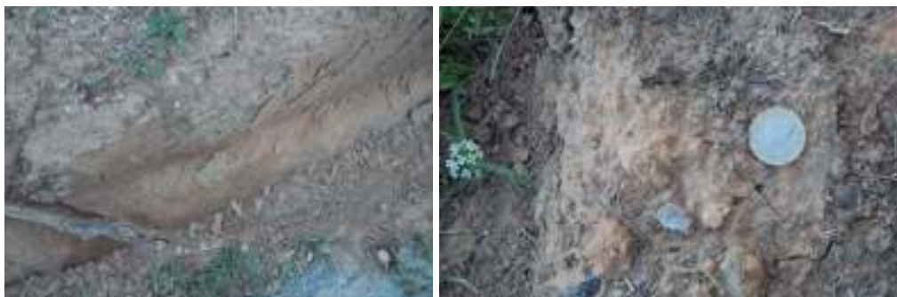
Figures 13 i 14: Dues mostres fotogràfiques dels materials ( aportacions 5 ) eluvionars de la Rasa. Foto esquerra, llims argilosos del quaternari antic, que omplen gran part de la conca de la Rasa. Foto dreta: Llims dels sondejors de pocs metres fets prop de la rotonda on hi havia l'antiga caseta de Turisme (el Pontet), arran d'un accident on s'hi abocaren carburants.
