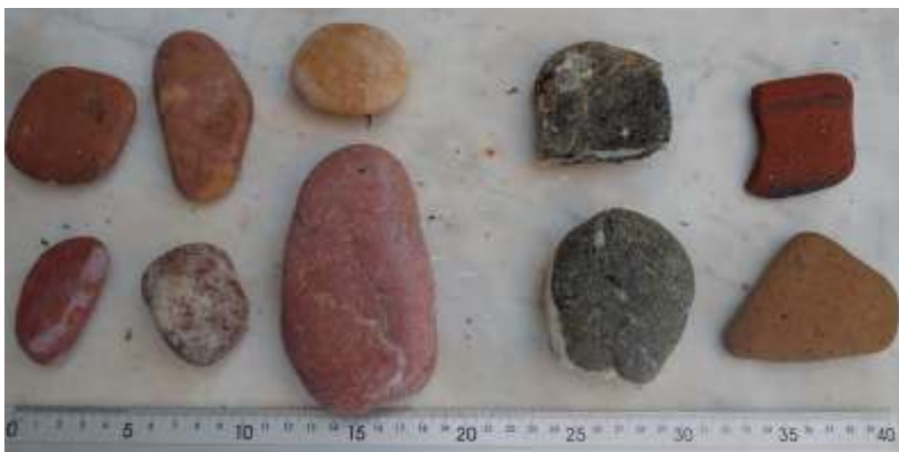
Figura 32: Els sis còdols de l'esquerra corresponen a calcàries cretàiques, del tipus de pedra de Santa Tecla , planars i molt arrodonits, de mida mitjana. Els dos còdols foscos intermedis corresponen a roques ígnies, abocades amb el sauló l'any 1994 , encara amb alguna aresta angular, després de vint anys arrossegant-se per la platja, i els dos còdols de la dreta corresponen a abocaments antròpics ceràmics , corresponents a una cassoleta a dalt i un tros de totxo a baix, que encara tenen alguna angulositat
