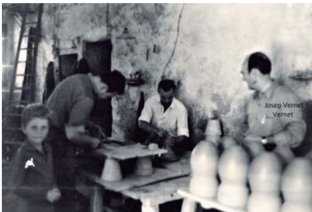
Fotografia 7: Activitat al taller de Cal Canterer de la Torre, abans del 1945 en un moment en què elaboren catúfols per a sínies. Fotografia cedida per Ramon Suñé Vernet
