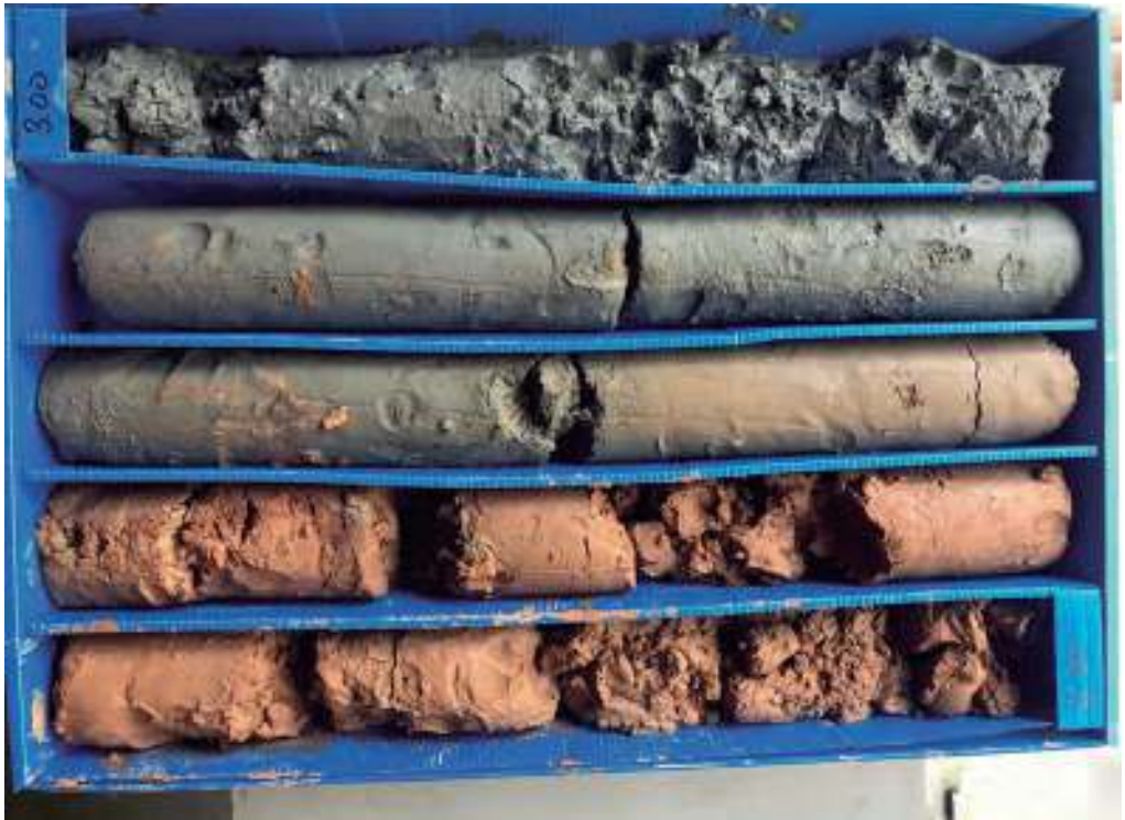
Fig. 7: Exemple de testimonis d'extracció continua on es travessen inalterades capes de llims i argiles rogencs i damunt trams de llots orgànics, on poder mostrejar
