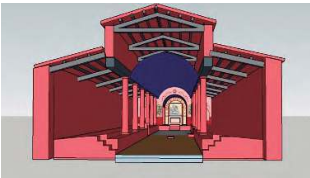
Fig. 12. Secció constructiva de la caverna (perspectiva autor)
